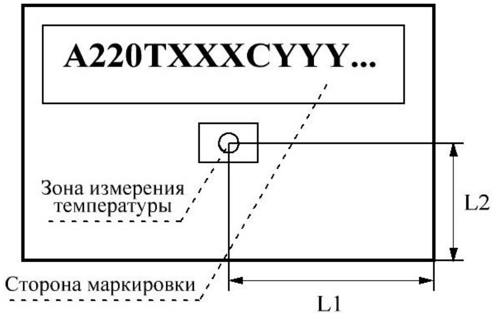
Рисунок Д.1 – Точка измерения температуры корпуса источника
